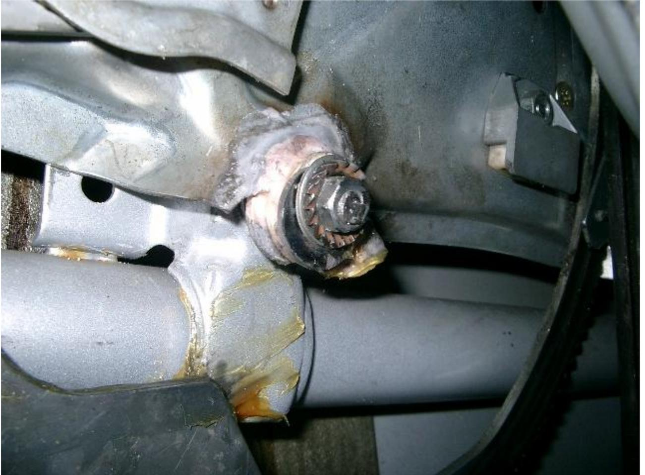
Il a fallu aussi replacer le moteur sur son support. BMW a trouvé la mauvaise/bonne idée de souder le support de moteur à la portiere. Moralité quand ca pete et qu'on cherche pas une solution bricolage c'est la portiere qu'il faut changer... Moi j'ai décidé de percer le support et la portiere et de revisser le tout.
