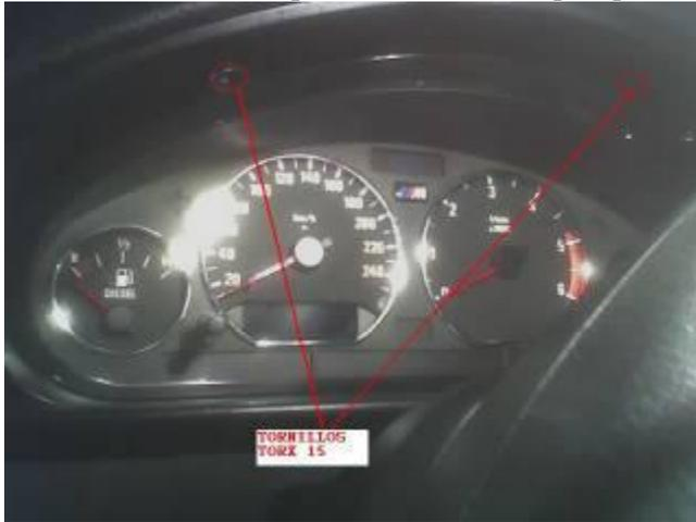
Después de quitar los tornillos, tiramos del cuadro hacia delante, se puede apalancar con un destornillador fino para tirar de él.
