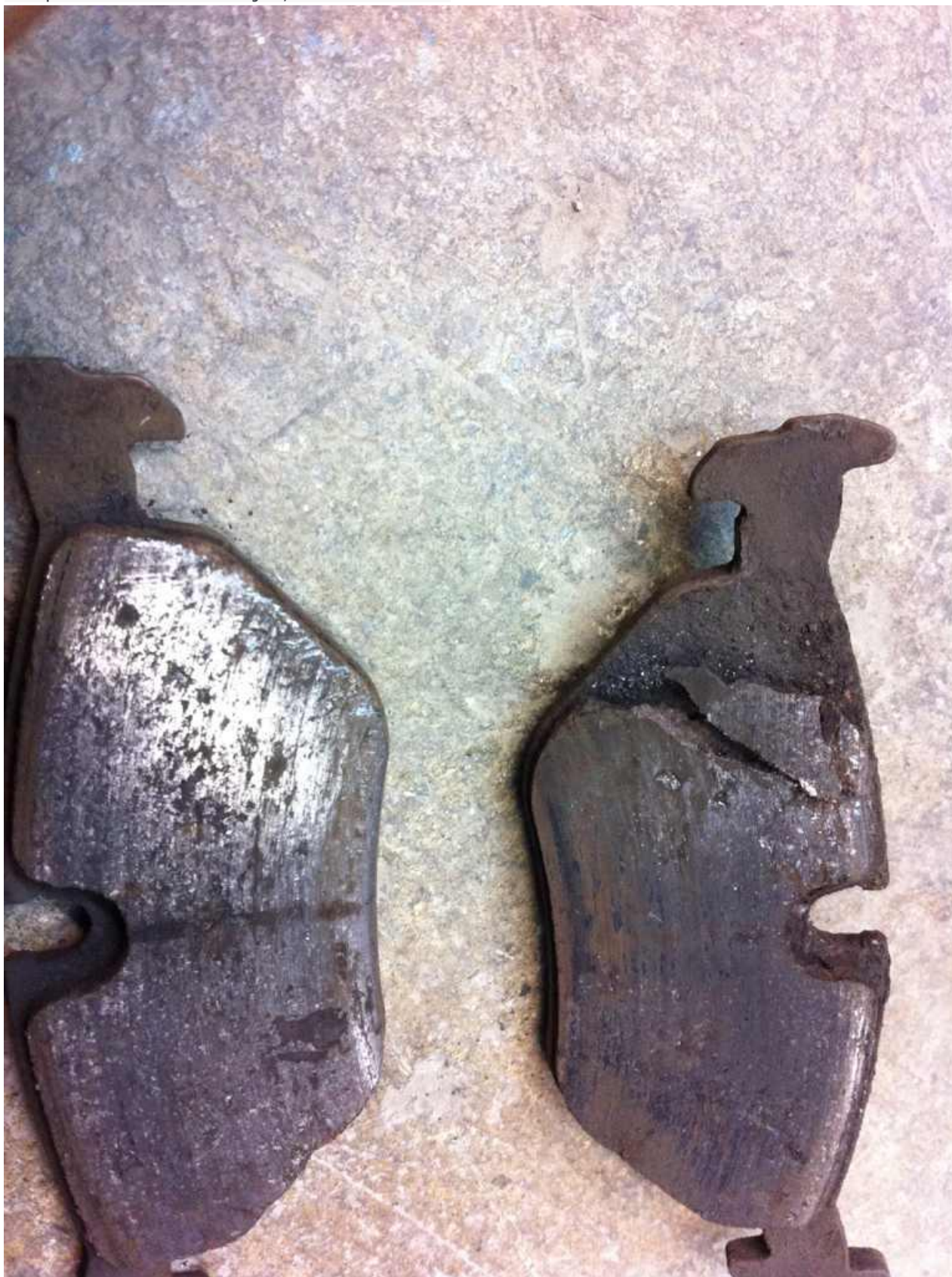
Las pastillas traseras viejas, destrozadas...:
