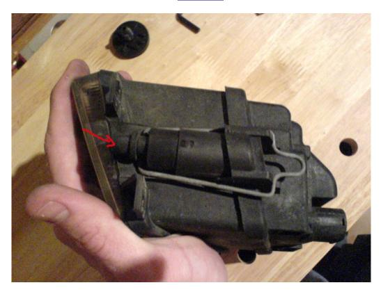
Ya metemos el faro en su sitio, enchufamos la clema que trae la corriente a la bombilla, apretamos los 2 tornillos que sujetan el antiniebla, colocamos la placa de plastico (muy fácil), y voilá!
