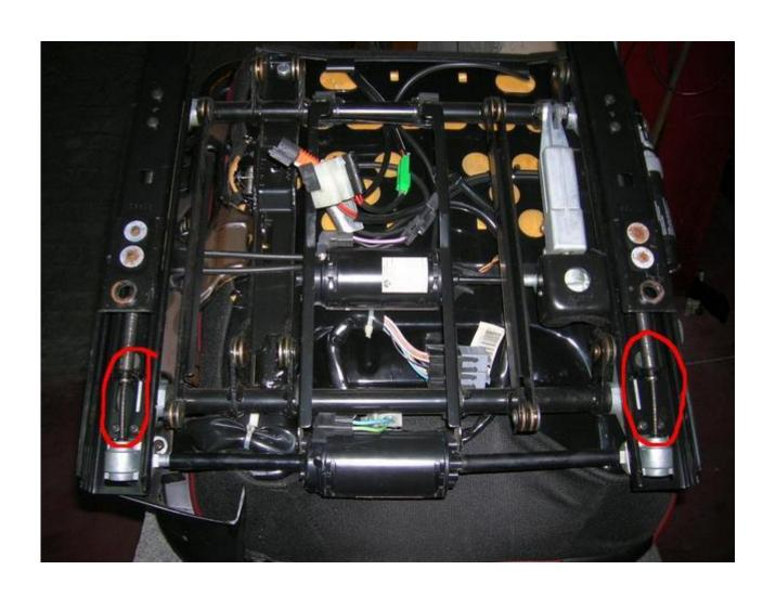
11- Para comprobar el funcionamiento y que todo funcione bien antes de meter el asiento en el coche lo mejor es meterle corriente directa al motor. No hay problema para hacerlo y es imposible que quemarlo, al meter corriente directa lo que conseguimos es mover el motor hacia un lado o a otro.
