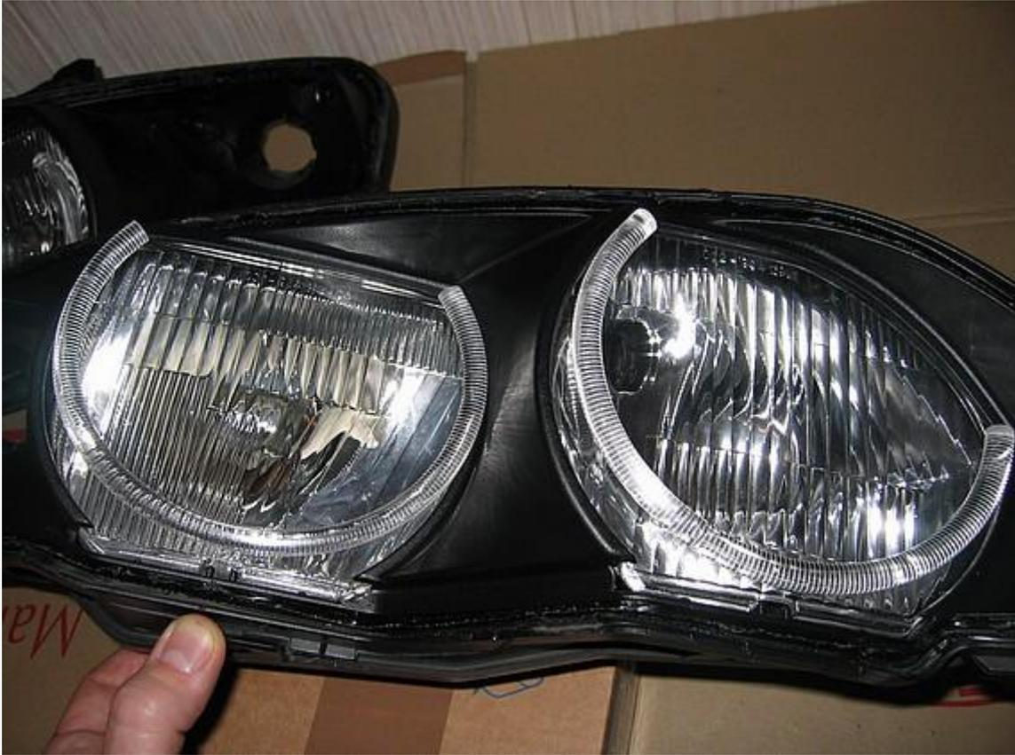
L'opération de perçage est délicate, entraînez-vous sur les chutes de plexiglas avant d'attaquer les anneaux
