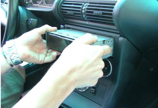
6: Dopo aver rimosso il pannello, svitare le viti che lo fissano al telaio. Il pannello di controllo non
